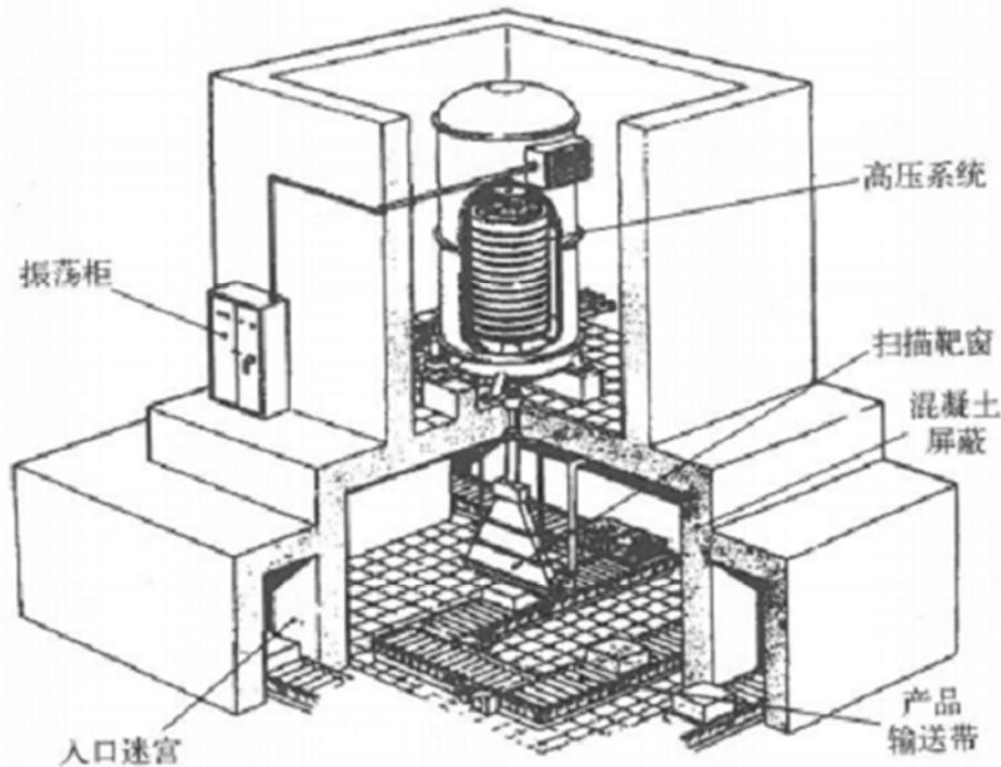
图 3-9 出入口控制型电子加速器
